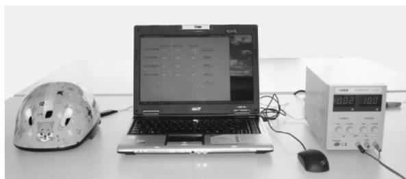
图1 头位倾斜自动测量仪主要由三部分组成:感应器及固定头盔(左)、计算机及相关程序(中)、稳压器(右)等。
