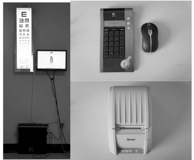
图5 全套视力自动化检查系统(机箱、显示器、蓝牙键盘和鼠标、打印机)。
